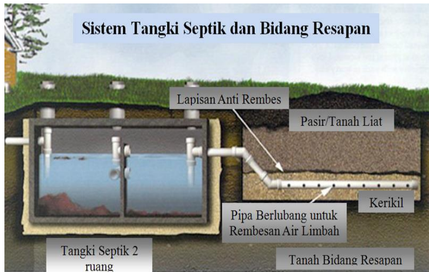
Gambar 3.24 Contoh Modul Bangunan Tangki Septik
